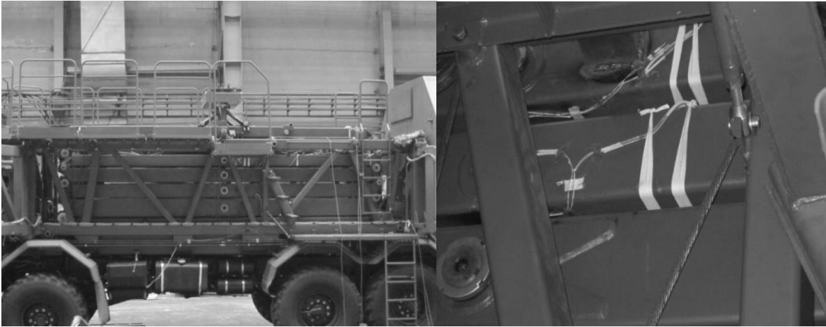
Рис. 4. Проведение экспериментальных исследований металлоконструкции подъемника в испытательном павильоне
