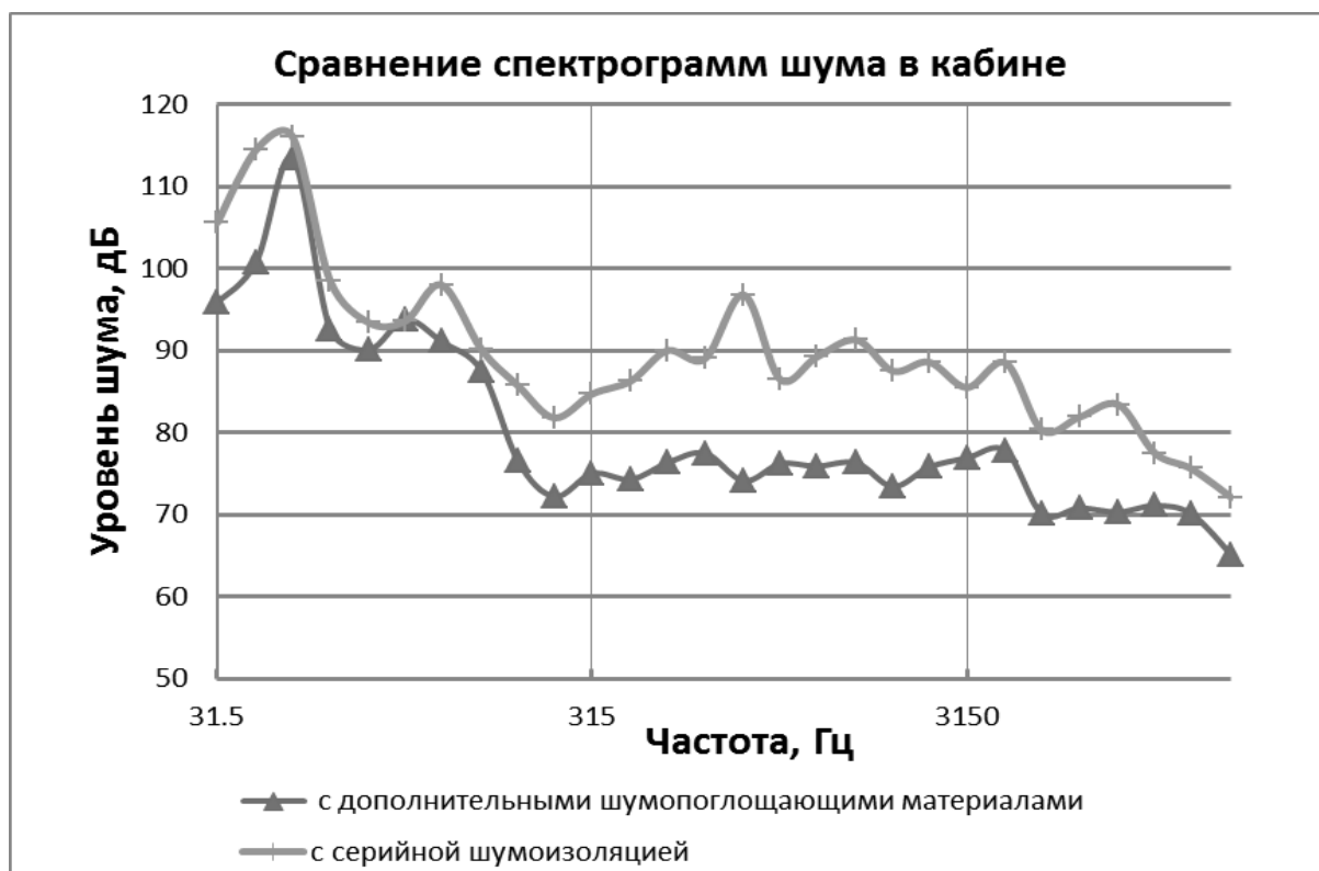
Рис. 1. Сравнение спектрограмм шума в кабине трактора
